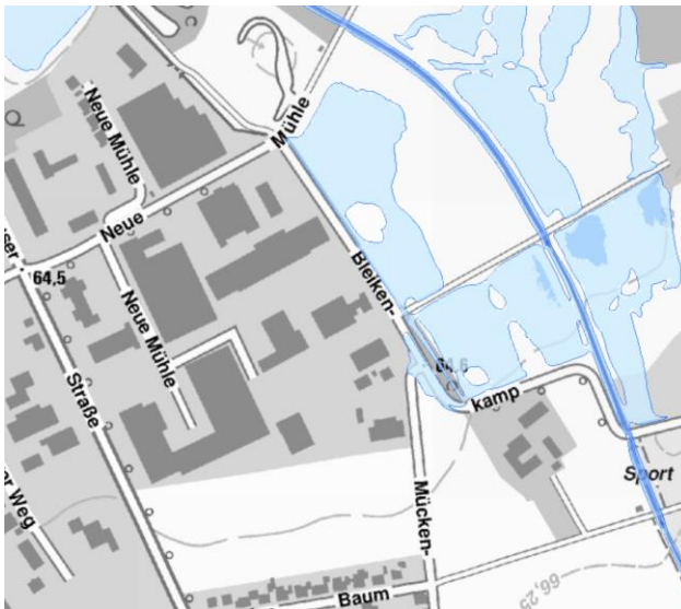
Abbildung 245: BOR-LEGD-006, Bei HQ 100 überflutete Bereiche, Quelle: https://www.klimaatlas.nrw.de/klima-nrw-pluskarte ; 06.09.2023
