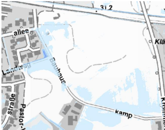
Abbildung 318: BOR-RHED-008, Bei Starkregen überflutete Bereiche, Quelle: https://www.klimaatlas.nrw.de/klima-nrw-plus-karte ; 11.09.2023
