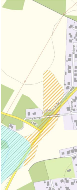
Abbildung 280: BOR-REKE-004, BK50 Bodenkarte NRW; Böden mit großem Wasserrückhaltevermögen (Kühlfunktion, Wasserhaushalt), Böden aus kreidezeitlichem Lockergestein; TIM online 06.09.2023
